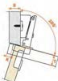
Esempio di montaggio con angolo a 105^\circ .
